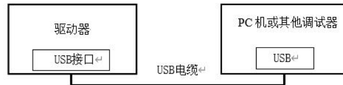
参数调试接线示意图
